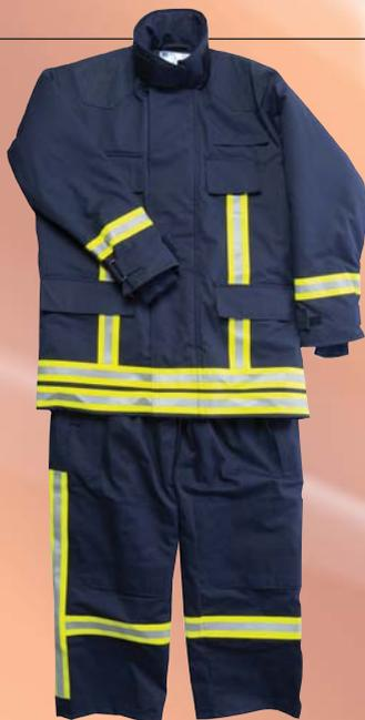
Боевая одежда пожарного, модель «Спотви» (артикул 230) состоит из куртки и брюк с теплоизоляционной подкладкой. Материал верха из термостойкой ткани 77 БА-032 с внутренним полимерным покрытием, темно-синего цвета.
