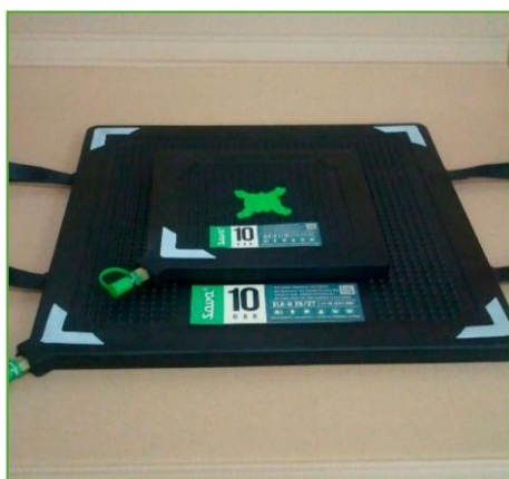
Рис. 5.22: Объединение обычных подъемных подушек для увеличения высоты подъема груза.
