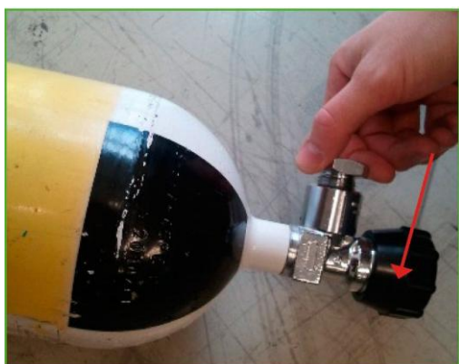
Рис. 5.5: Удалите предохранительную пробку из крана баллона со сжатым воздухом.
